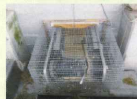
集卵用コンベアや除糞ベルトの開口部の隙間対策。(写真は、稼働時以外はカバーを設置し、隙間をなくしている事例。)
