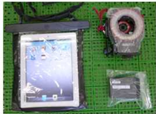
【写真1】撮影に用いる機材 消毒薬に浸漬するため機材に防水カバーを装着している (左)タブレット型端末 (右上)カメラ及び補助ライト (右下)インターネットルーター
