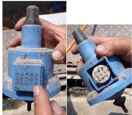
図 調圧器フィルターの埃
