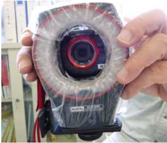
【写真2】撮影用カメラ 防水型カメラのレンズを取り囲むように、LED光源の補助ライトを装着している。
