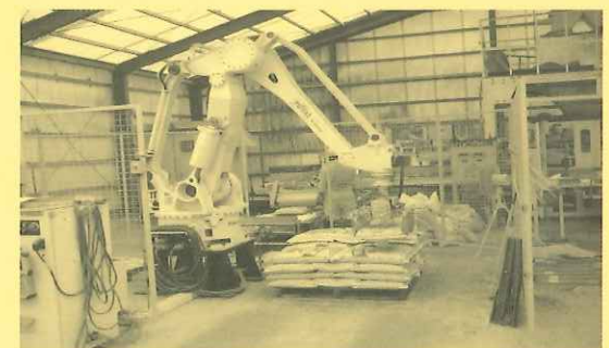
写真8 時間700袋の袋詰めが出来る梱包機と 段積みロボット
