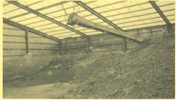
写真2 鶏舎から搬出される鶏ふんはベルトコンベアで直接堆肥舎に運ばれ約1か月予備発酵させる
