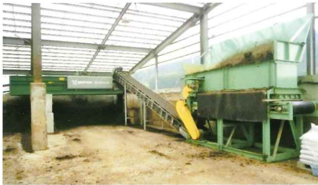
写真3 堆肥篩選別機による木材チップの除去
