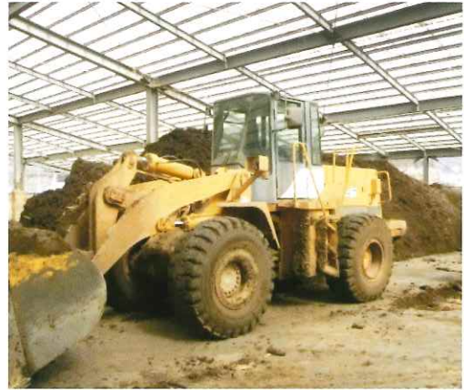
写真2 ショベルローダーによる切り返し
